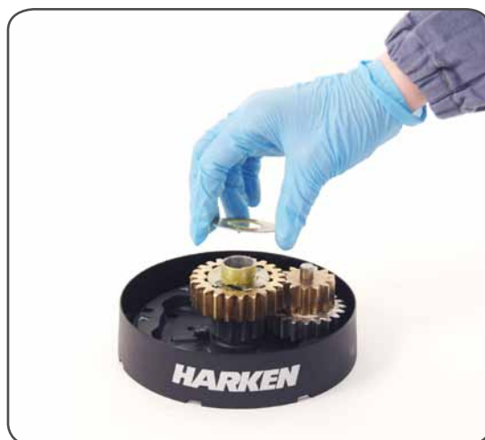
11. Remove the washer n°12
