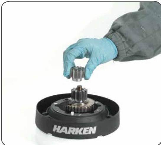
13. Remove the gear n°3
