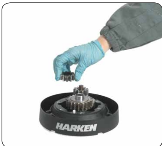
10. Remove the gear n°16
