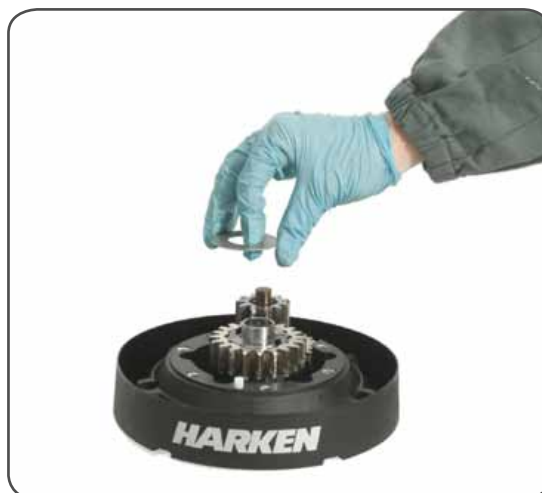
11. Remove the washer n°14
