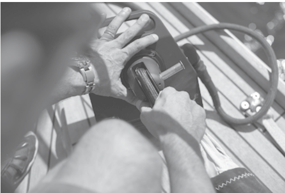
Attacher le point d'amure de la voile sur la chape du motoréducteur Attach the sail tack point to the fork of the gear motor
